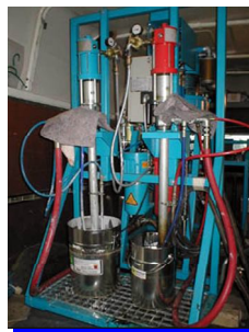
Aplicare la un canal de gaze arse, prin metoda pulverizarii airless, in doua componente
